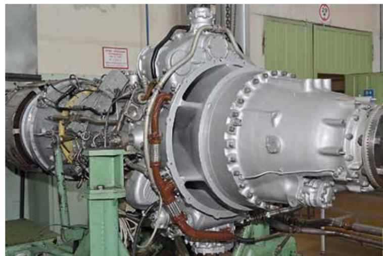
Двигатель AI-20 на стенде после ремонта
